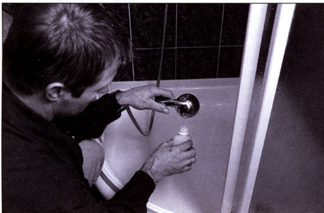
Probeentnahme in der Dusche
